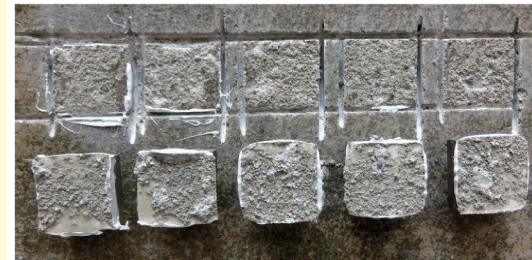
▲図1: 無処理コンクリートの破壊状況(表層部破壊)
