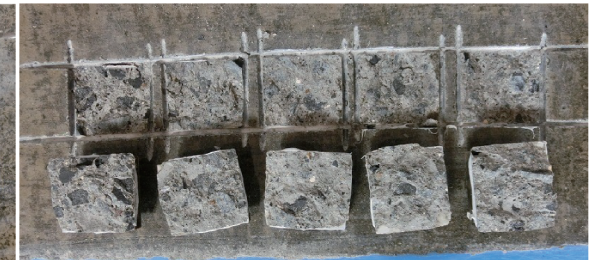
▲図2: ベストフロー処理コンクリートの破壊状況(コーン破壊)
