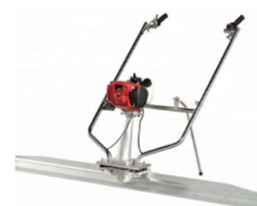
写真5 振動スクリーン
